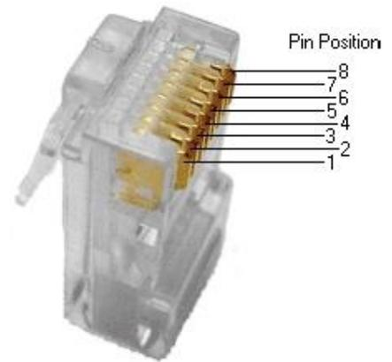
Weitere Wechselrichter werden, wie im Handbuch von GoodWe beschrieben, in Reihe angeschlossen. D.h. der zweite WR wird am ersten angeschlossen, der dritte WR am Zweiten usw. Dazu kann ein einfaches, nicht gekreuztes RJ-45 Patchkabel verwendet werden.
